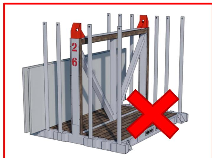
**Interdiction de lever le box à vide ou à plein en se fixant sur les accroches inférieures.**
