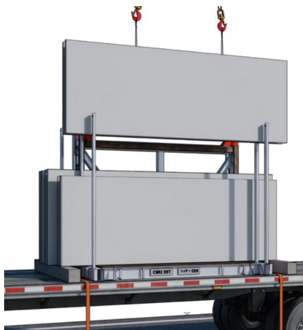
3° )Retirer le prémur du box en partant de l'extérieur du box et en alternant de gauche à droite pour éviter tout risque de basculement.
