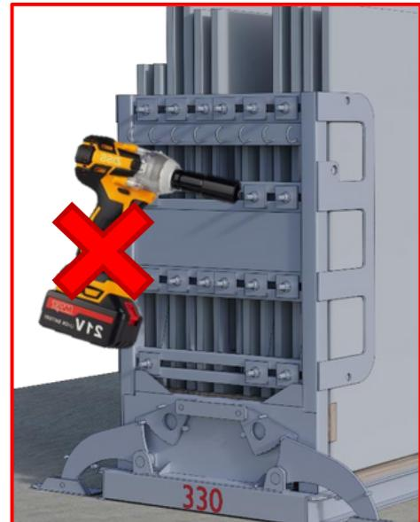
Interdiction de desserrer les écrous des flasques.
