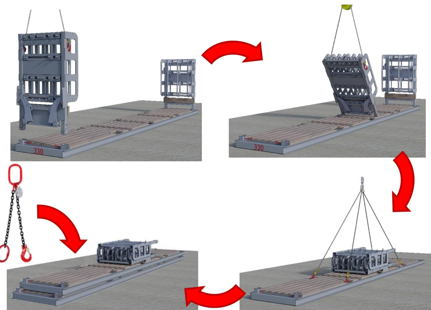
En cas de reprise de plusieurs racks, déposer les échelles à l'horizontale au milieu du rack du dessus afin d'empiler les racks correctement. Paquet de 3 racks maximum pour évacuation en remorque surbaissée. Vous pouvez déposer jusqu'à 4 racks maximum pour un retour par plateau.
